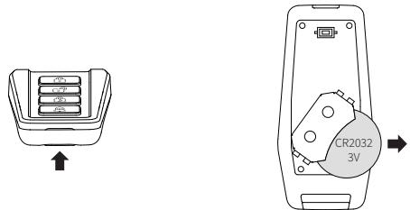
① För in en liten skravmejsel i fjärrkontrollens öppning och bänd upp den för att öppna baksidan.
